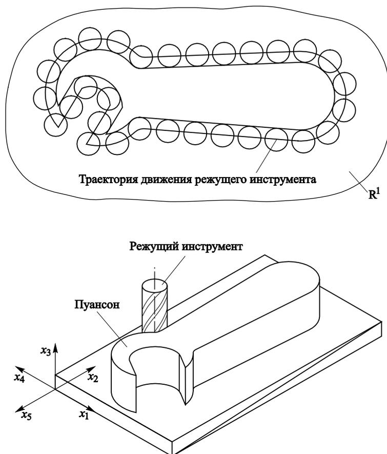
**Рис. 1.** Обработка пуансона на 5-координатном станке с числовым программным управлением. Размерность операционного пространства  $n = 1$ , т. е. это пространство является одномерным ( $R^1$ )
