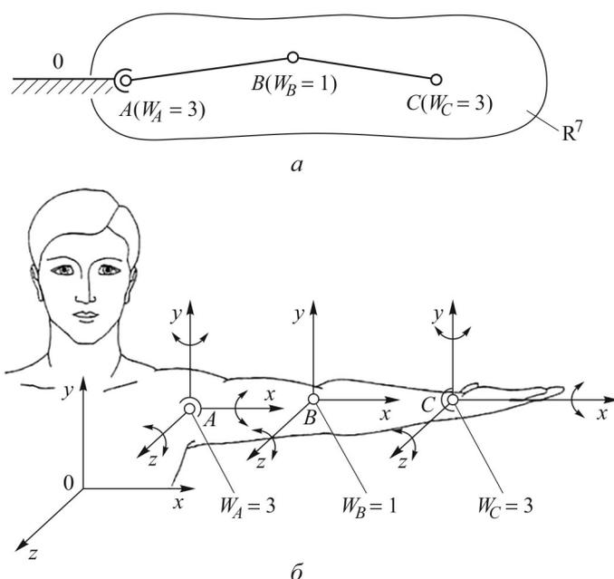
**Рис. 2.** Структурная схема (а) промышленного робота, имитирующего движение рук человека (б). Размерность операционного пространства, содержащего данный механизм,  $W = 7$  (соответствует 7-мерному пространству  $R^7$ )
