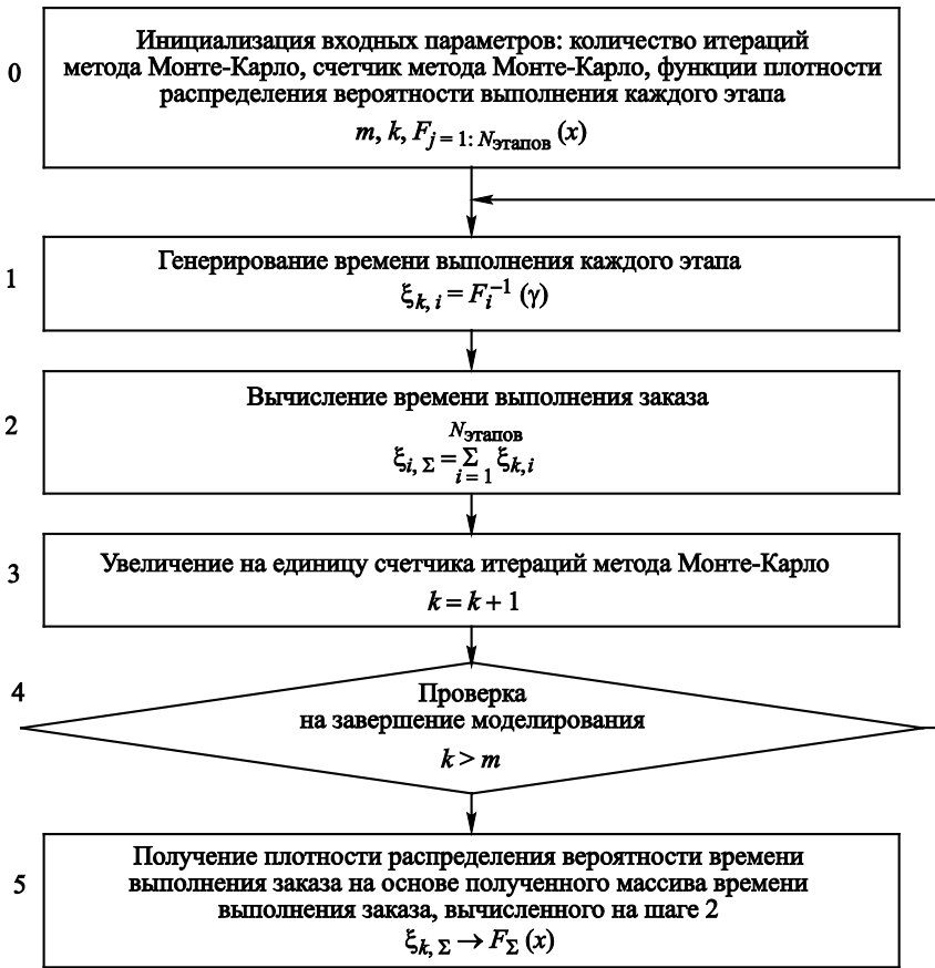
Рис. 2. Алгоритм расчета плотности распределения вероятности времени выполнения цикла снабжения
