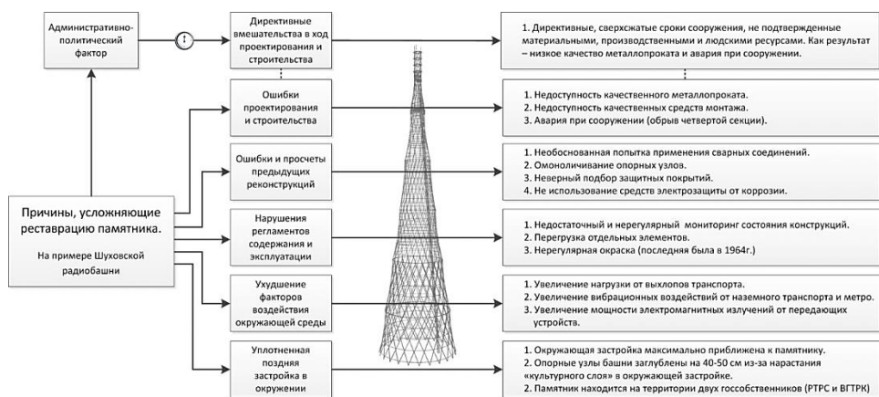
Рис. 2. Аналитическая карточка. Факторы, усложняющие реставрацию и содержание Шуховской радиобаши
