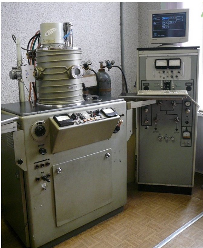
Рис. 1. Лабораторная вакуумная технологическая установка Balzers-350G
